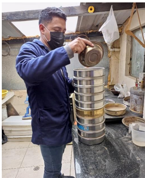
Figura 27. Ensayo de granulometría por tamizado.
