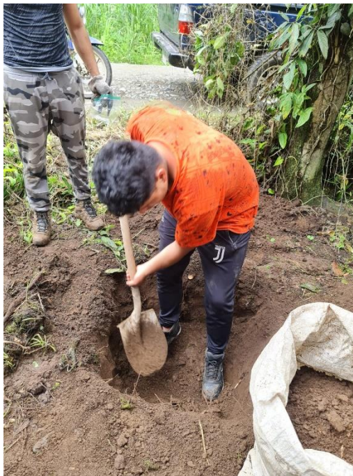
Figura 49. Extracción de muestra de suelo para analizar en laboratorio.
