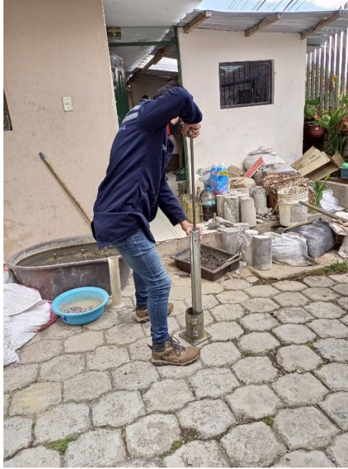
Figura 52. Realización de ensayos de suelos, Proctor modificado.
