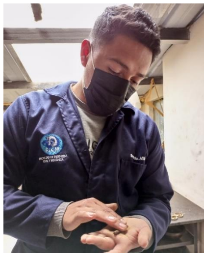
Figura 31. Ensayo de límite plástico.
