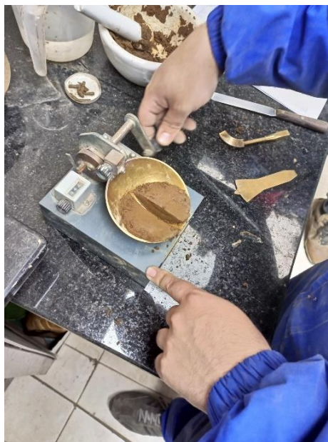
Figura 30. Ensayo de límite líquido empleando la Copa de Casa grande.
