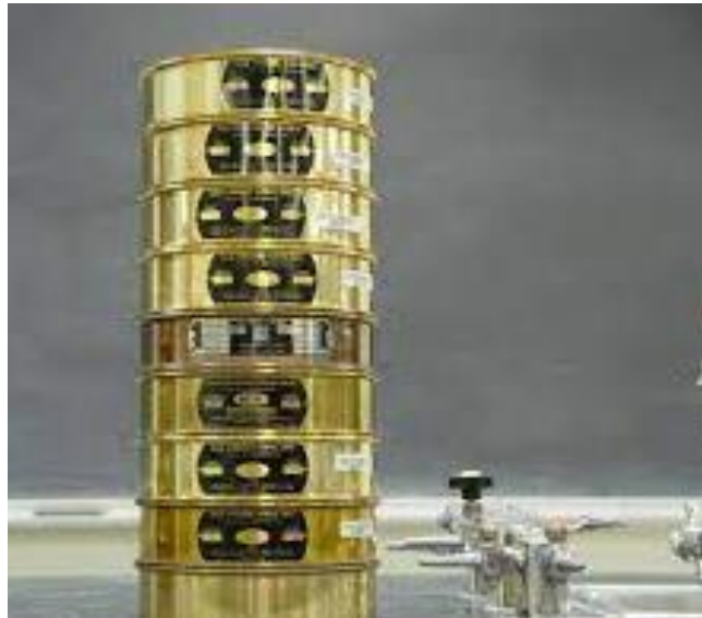
Figura 7. Tamices empleados en el ensayo de granulometría.
