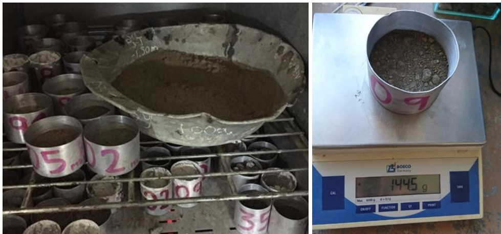
Figura 25. Ensayo de contenido de humedad de suelo.
