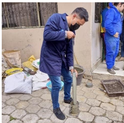
Figura 32. Ensayo de Proctor modificado.
