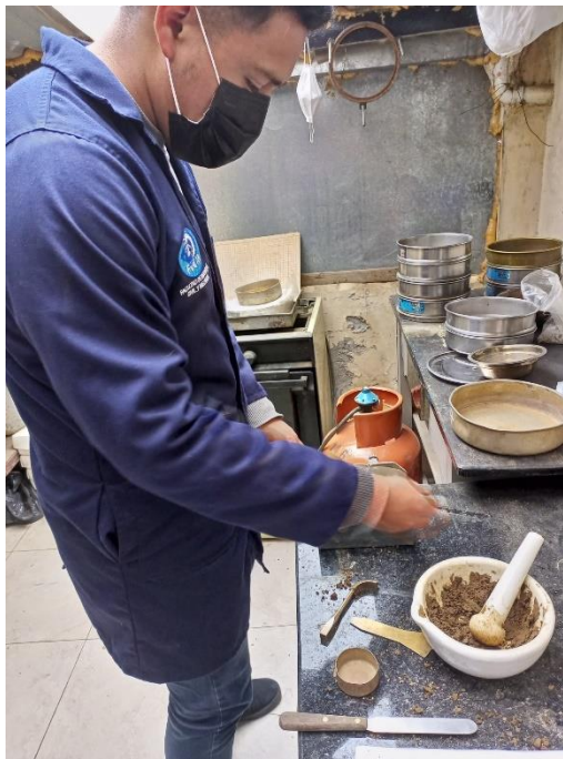
Figura 51. Realización de ensayos de suelos, límites de Atterberg.
