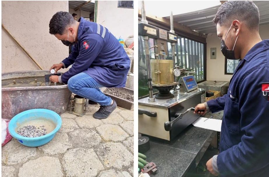
Figura 35. Realización del ensayo de CBR.
