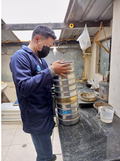
Figura 50. Realización de ensayos de suelos, granulometría.
