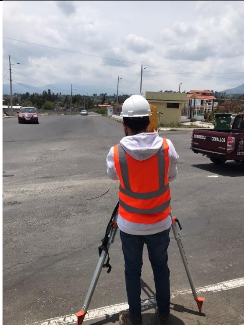
Nivelando el trípode y la estación total para iniciar con la toma de puntos.
