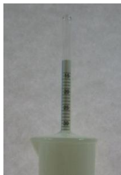
Fig. 2.1: Medición de la densidad del suero lácteo.
