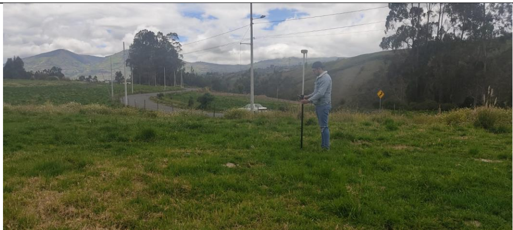
Toma de puntos para la franja topográfica.
