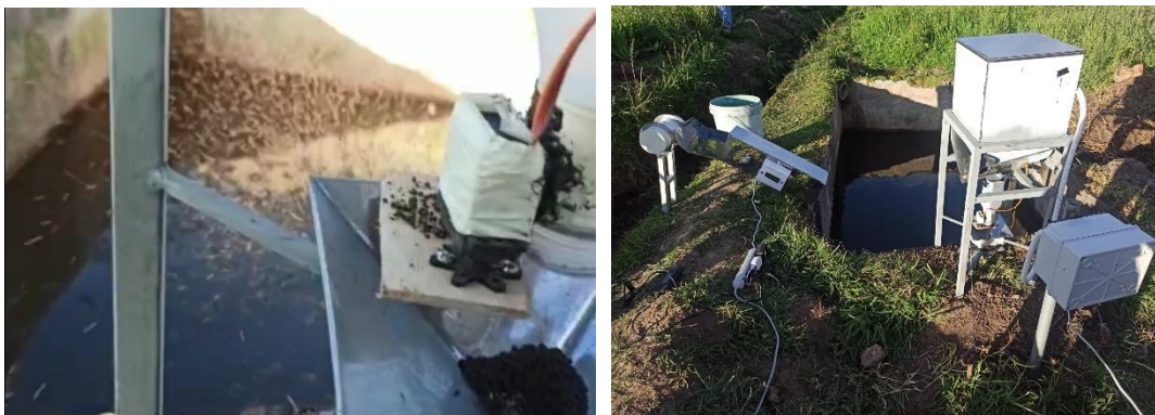
Figura 151: De izquierda a derecha. Dispensación del balanceado y contador de alevines junto al dispensador de alimento
