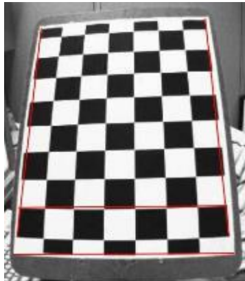
Figura 58: Distorsión radial en un tablero de ajedrez
