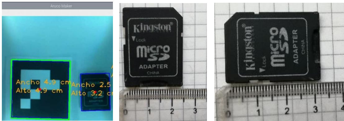
Figura 69: De izquierda a derecha: Se captura el tamaño de un adaptador SD. Se mide el tamaño mediante una regla del ancho de la tarjeta. Se mide el alto de la tarjeta
