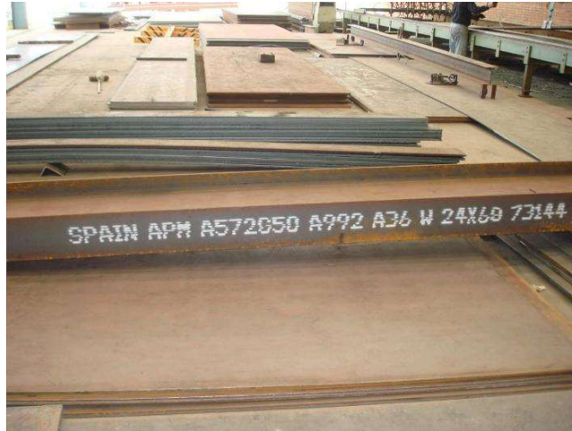
Figura 4. Perfil laminado en caliente que cumple con varias especificaciones ASTM [9]
