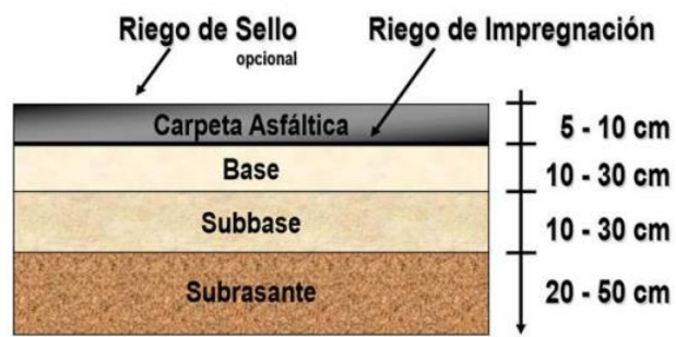
Figura 1: Sección Transversal de un Pavimento Flexible
