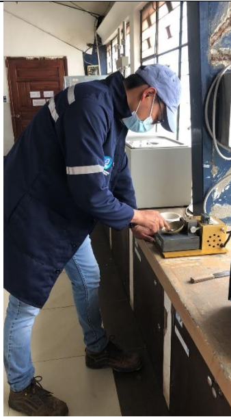
Ensayo de límite líquido con la Copa de Casagrande
