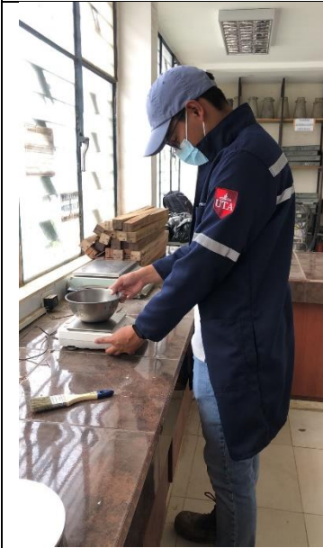
Pesaje de muestras retenidas en cada tamiz para el ensayo de granulometría
