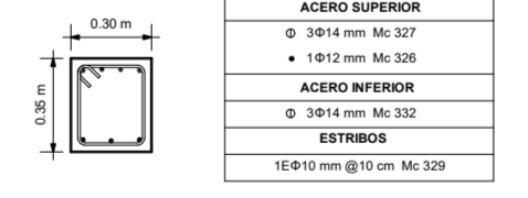
CORTE DE VIGA 15-15 ESCALA 1:20
