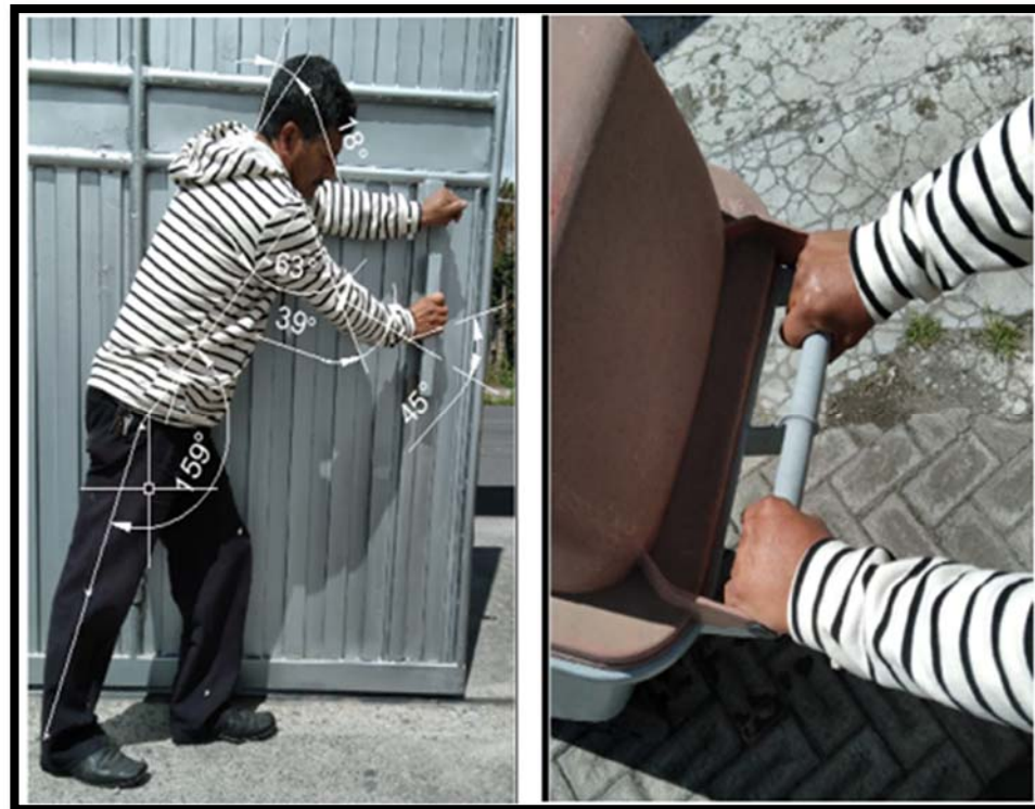
Figura 13: Ángulos en el puesto de trabajo del Portero.
