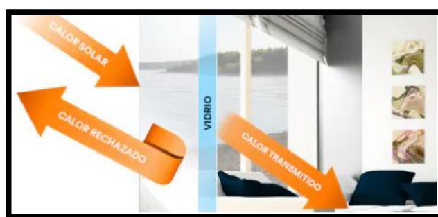
Fig 43. Funcionamiento de las películas de control solar [80].
