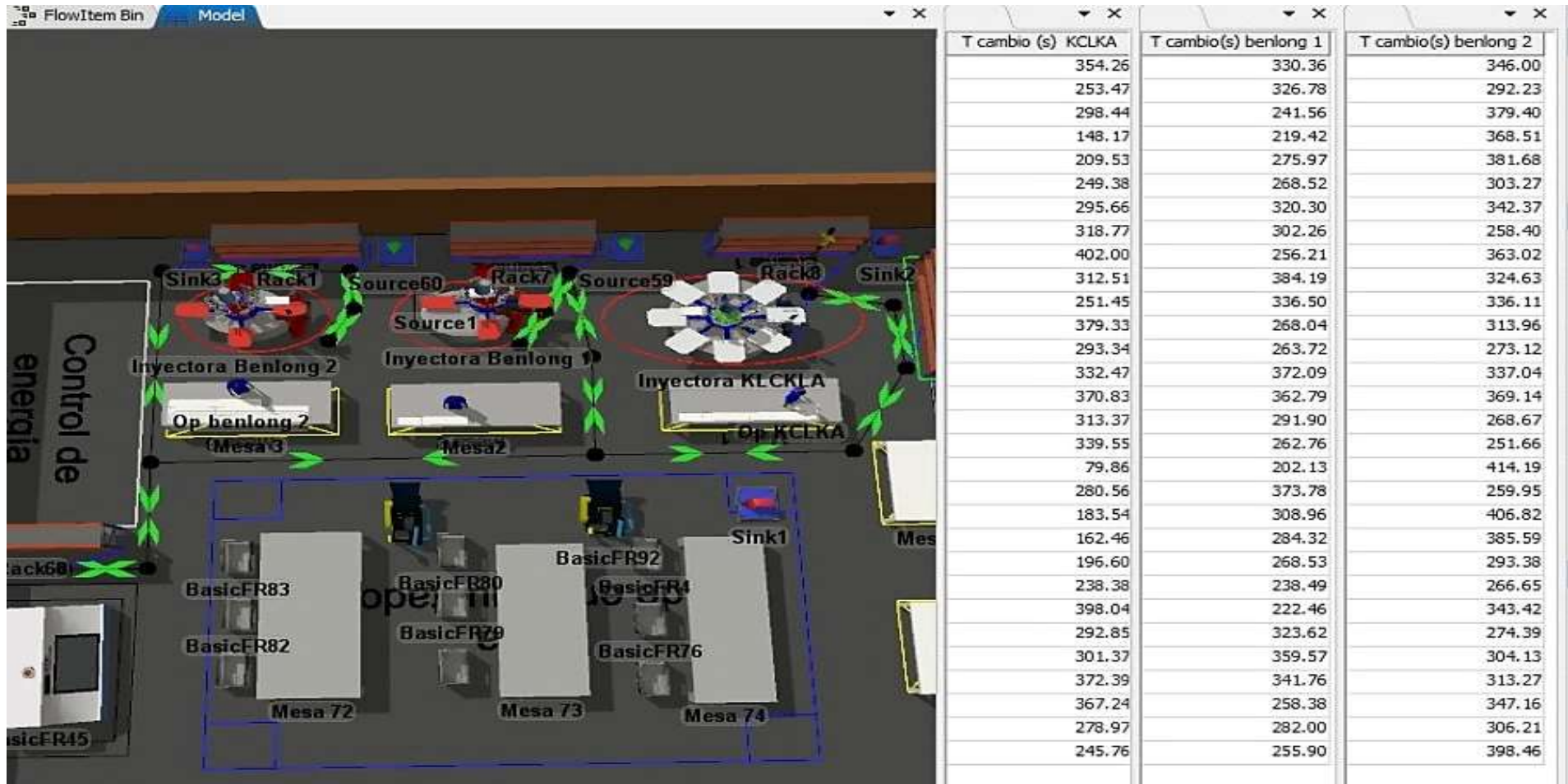
Figura 62. Tiempos de cambios de molde de mejora SMED proporcionados por FlexSim
