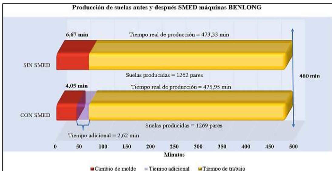
Figura 47. Producción de suelas antes y después de SMED máquinas BENLONG
