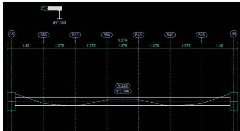
Figura 52 Relación demanda/capacidad viga arriostrada
