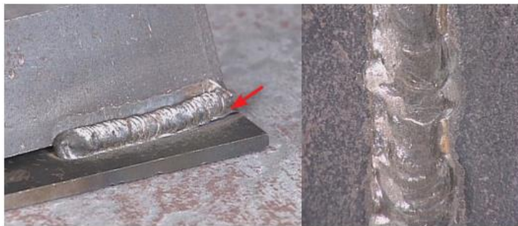
Fig. 11 Falta de fusión [37]
