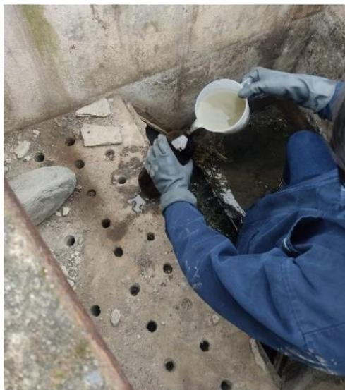
*Figura 13. Recolección de muestras de agua residual de la PTAR.*
