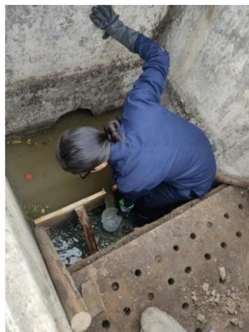
*Figura 11. Medición del caudal de ingreso a la PTAR.*
