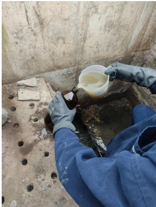
**Figura 46.** Recolección de muestra de agua residual para análisis en el laboratorio.
