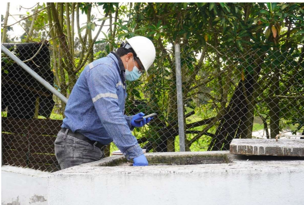
Figura 33. Medición de Caudal de ingreso a la PTAR
