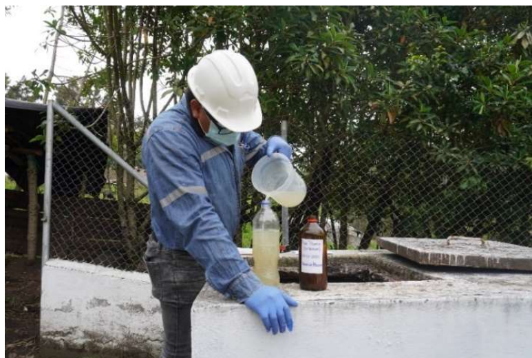
Figura 17. Obtención de muestra a la entrada de la PTAR. Fuente: El Autor
