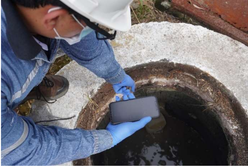
Figura 16: Medición del caudal a la salida de la PTAR. Fuente: El Autor
