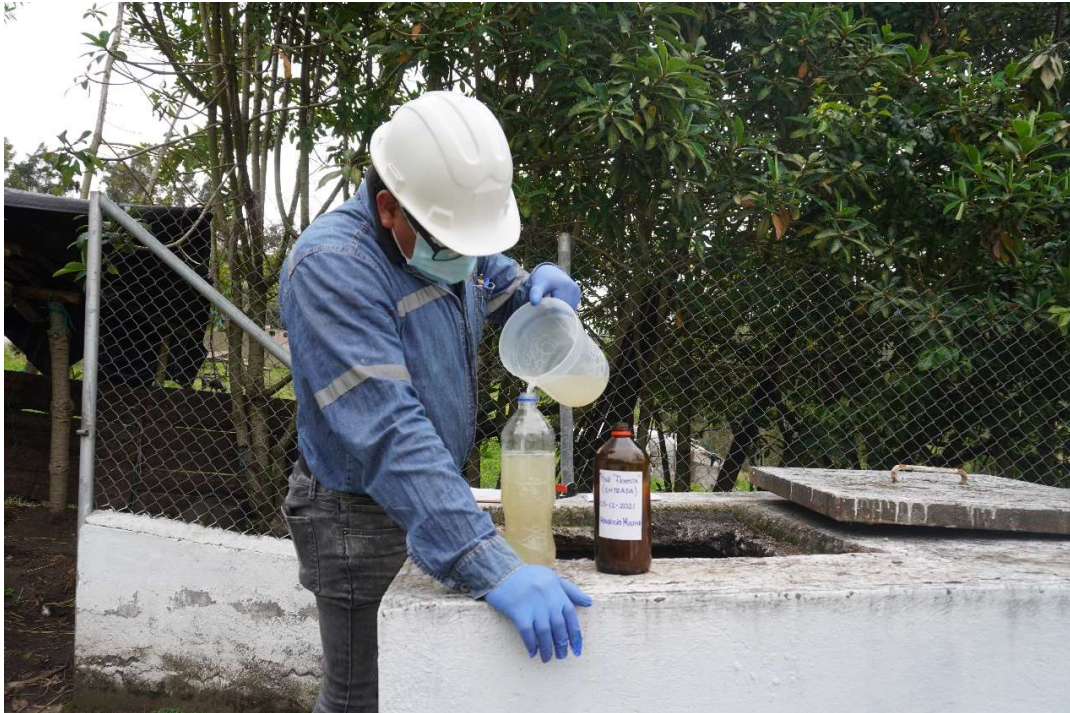
Figura 35. Toma de muestra de agua del ingreso a la PTAR
