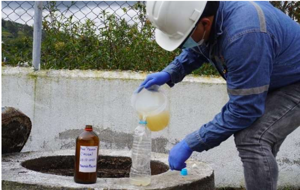
Figura 18: Obtención de la muestra a la salida de la PTAR. Fuente: El Autor
