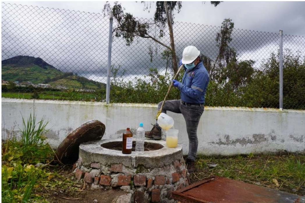
Figura 36. Toma de muestra de agua de salida de la PTAR
