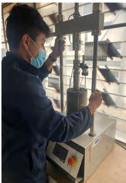
FOTOGRAFÍA 7.- Ejecución del ensayo CBR.
