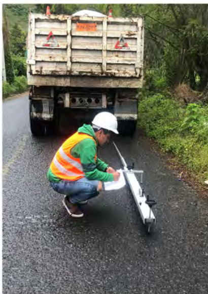
FOTOGRAFÍA 3.- Toma de lecturas de deflexiones durante el ensayo de viga Benkelman
