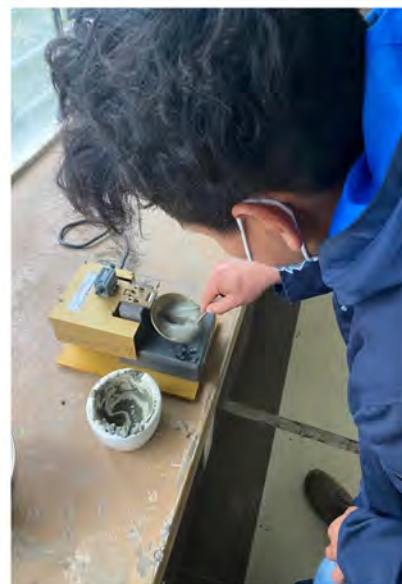
FOTOGRAFÍA 6.- Ensayo de límites de Atterberg.
