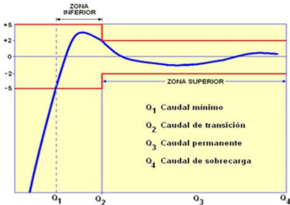
Figura 4: Curva de característica de un medidor de agua potable
