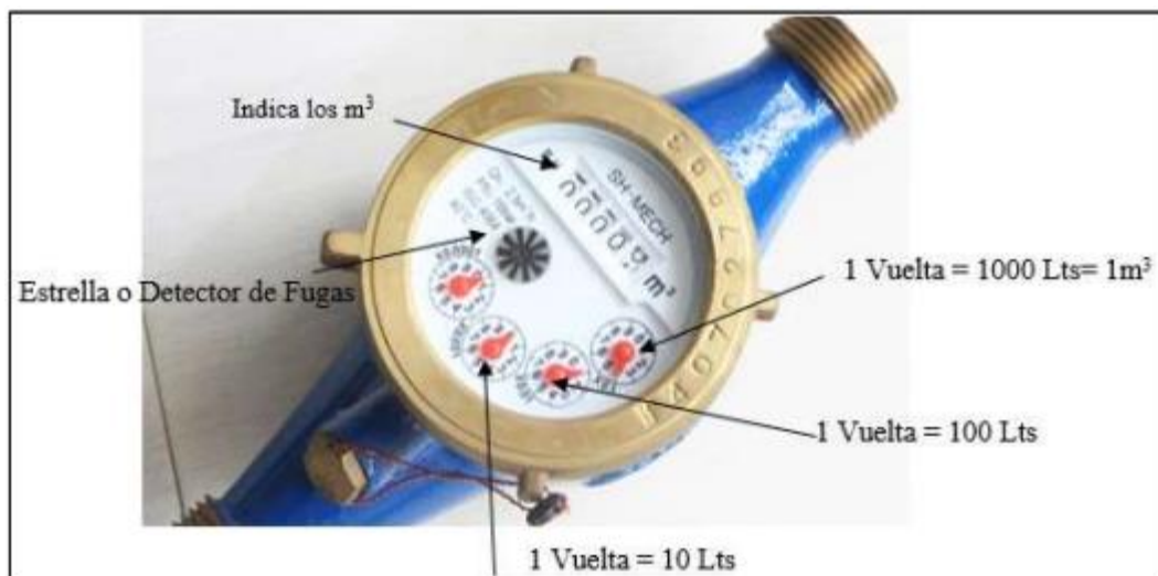
Figura 16: Interpretación de marcación en un medidor
