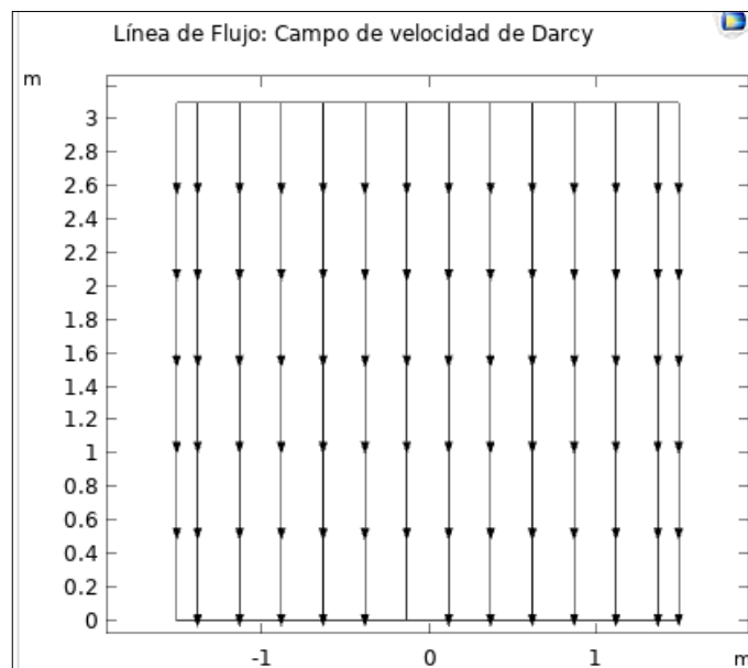
Figura 11. Líneas de flujo del biofiltro percolador
