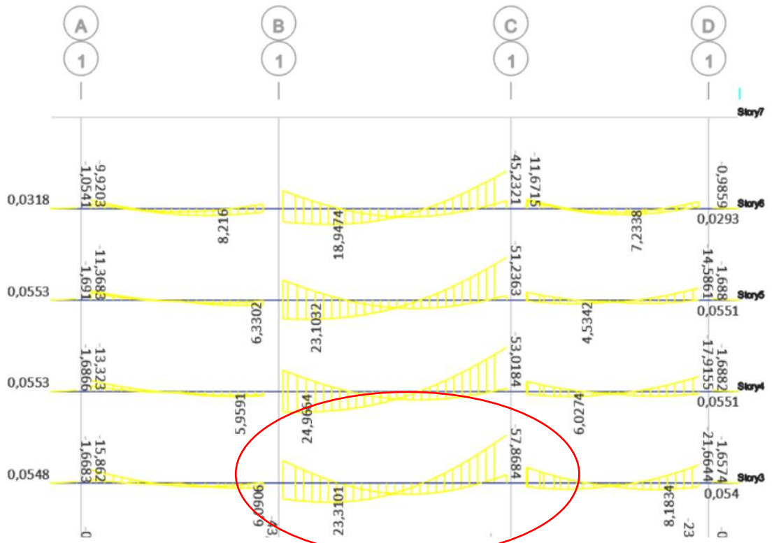
Figura 57. Momento último, viga eje Y (1 B-C) 35x70 cm, Nivel N+6.48 m
