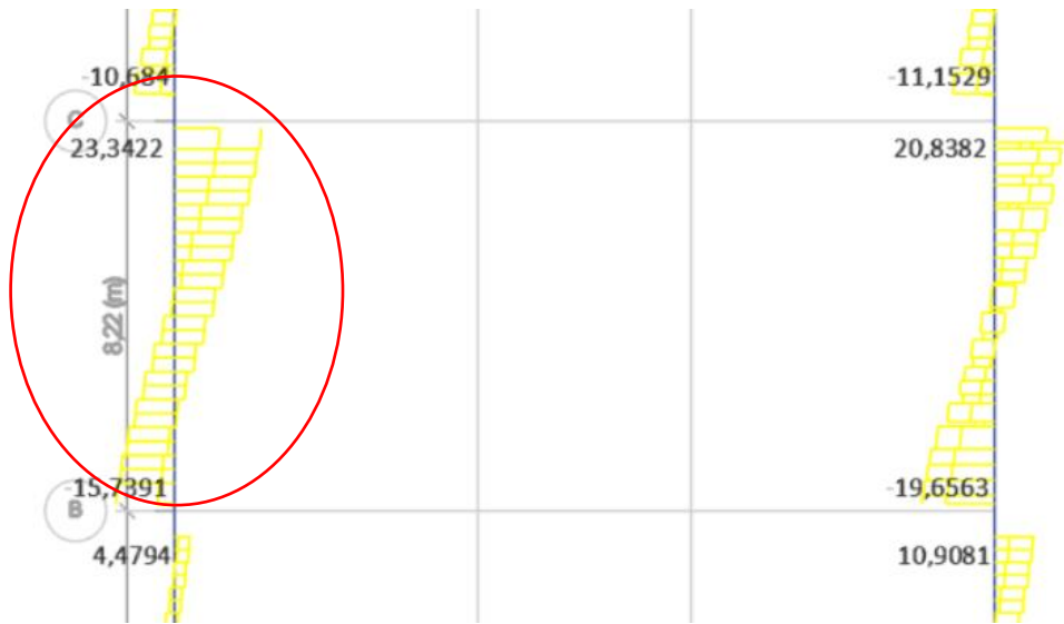
Figura 62. Cortante último, viga eje Y (1 B-C) 35x70 cm, Nivel N+6.48 m
