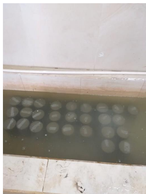
Figura 56. Probetas de hormigón en proceso de curado
