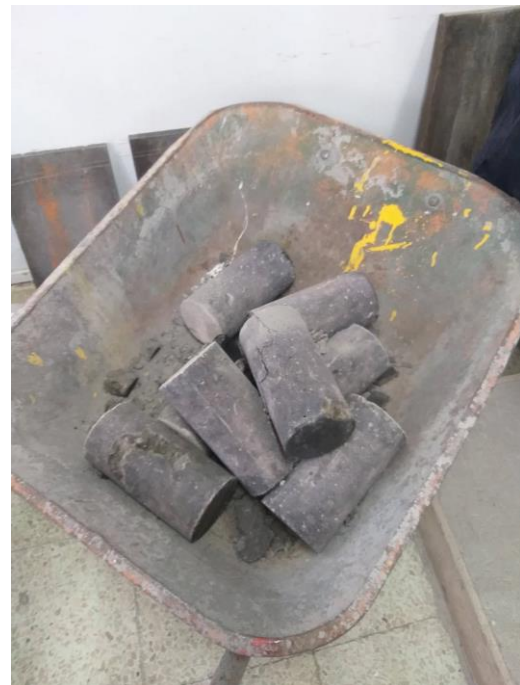
Figura 60. Probetas ensayadas a compresión
