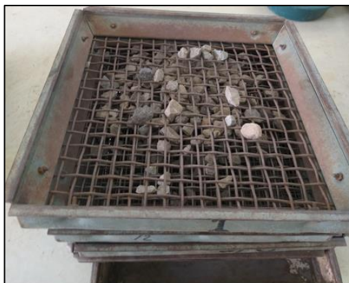
Figura 7. Ensayo para determinar el TNM del ripio
