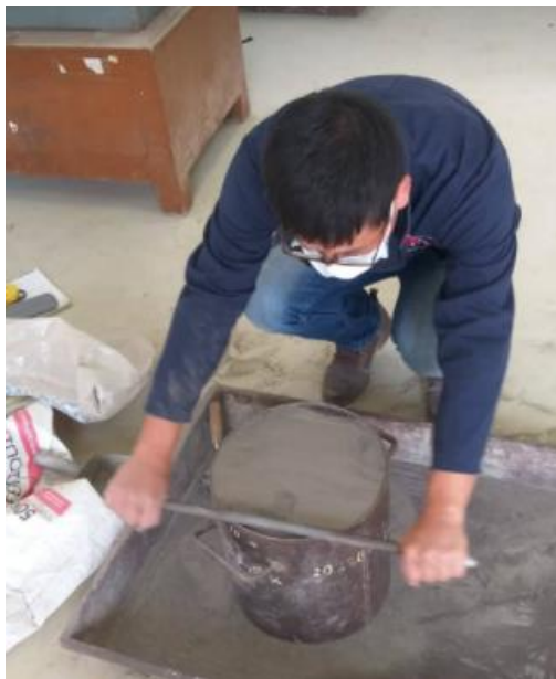
Figura 47. Ensayo de densidad aparente suelta del agregado fino
