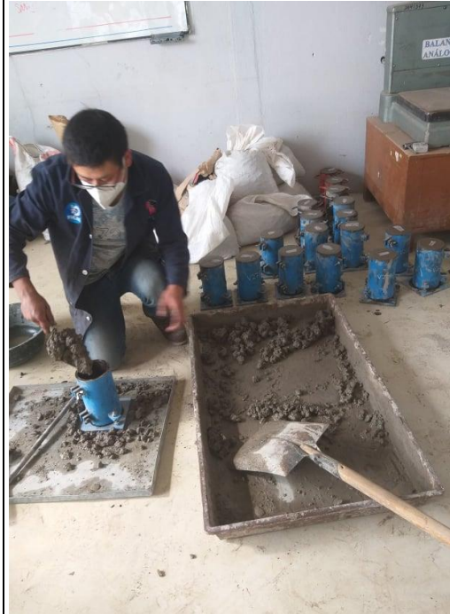
Figura 54. Elaboración de las probetas de hormigón
