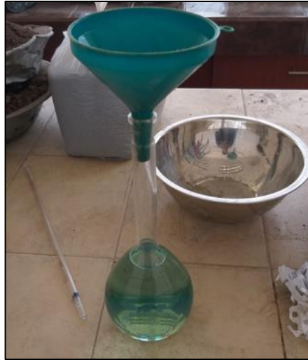
Figura 12. Ensayo de densidad real del cemento
