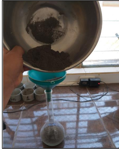
Figura 13. Ensayo de densidad real de la arena
