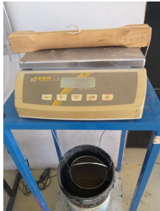
Figura 50. Ensayo de densidad real del agregado grueso
