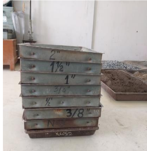
Figura 46. Ensayo granulométrico del agregado grueso
