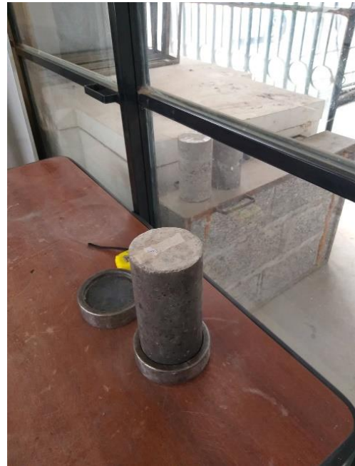
Figura 58. Colocación de las placas de neopreno a la probeta de hormigón
