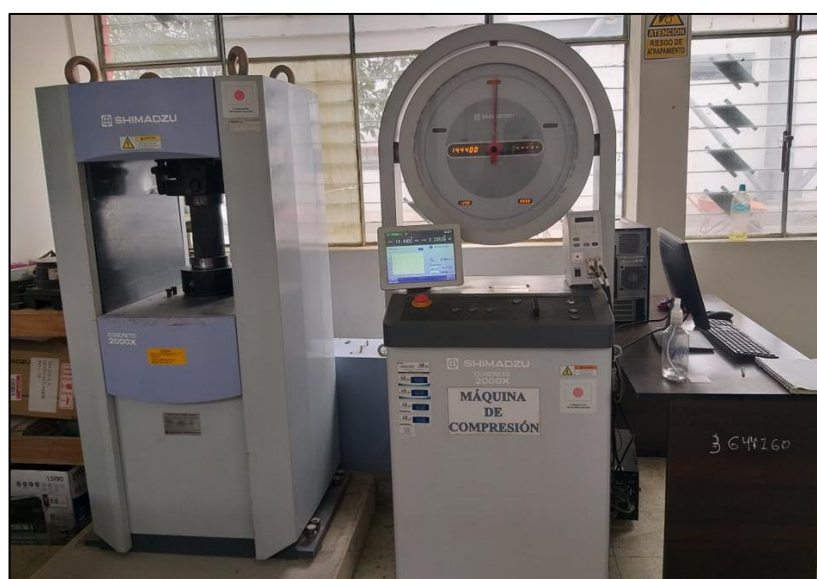
Figura 25. Máquina de compresión SHIMADZU CONCRETO 2000X
