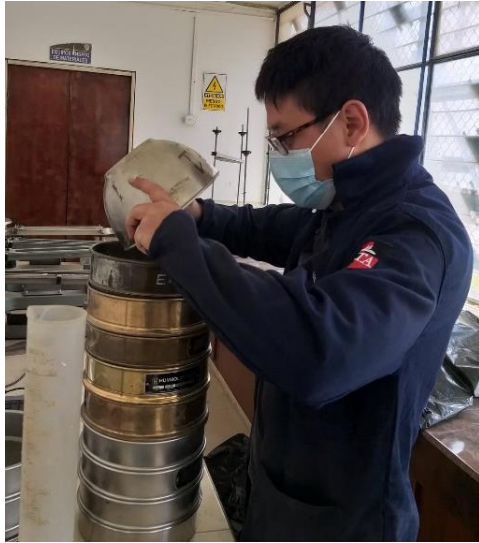
Figura 45. Ensayo granulométrico del agregado fino
