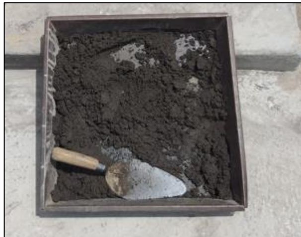
Figura 9. Secado de la arena hasta obtener el estado SSS
