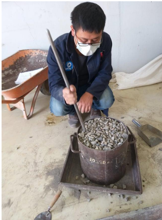
Figura 49. Ensayo de densidad aparente compactada del agregado grueso
