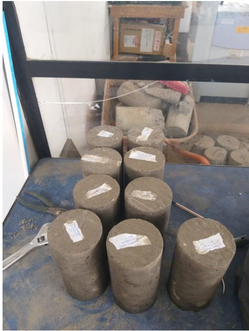
Figura 57. Secado de las probetas de hormigón
