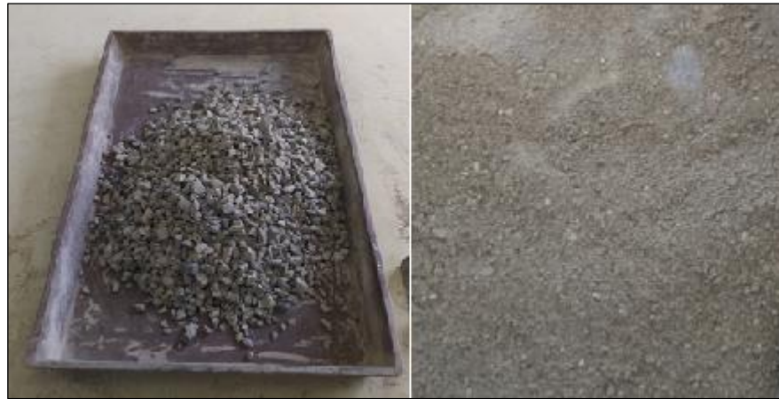
Figura 2. Ripio(izq.) y arena (der.)
