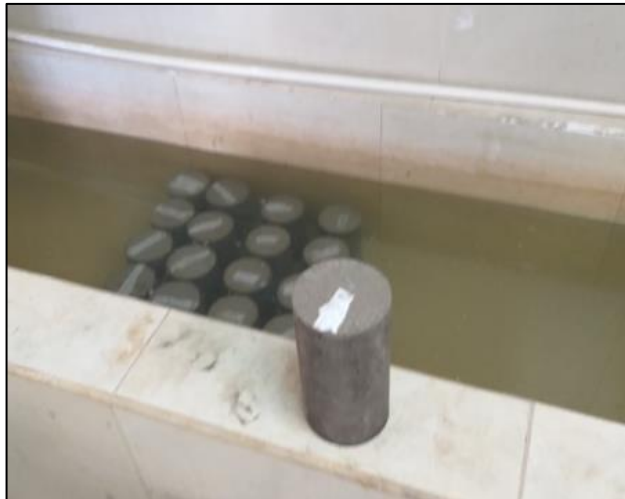
Figura 24. Tanque de curado
