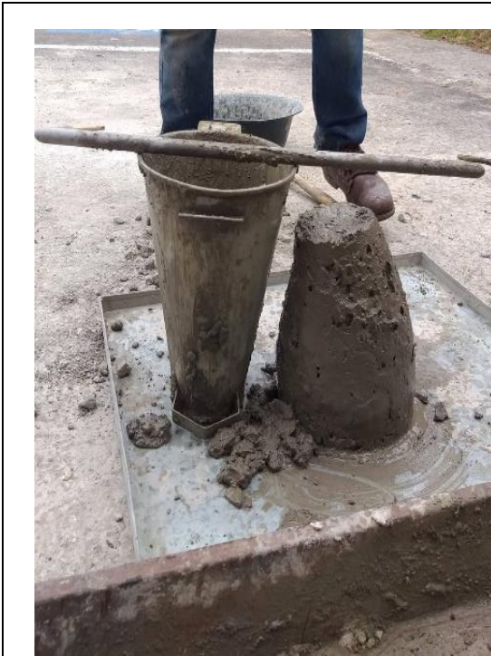
Figura 53. Ensayo de asentamiento del hormigón
