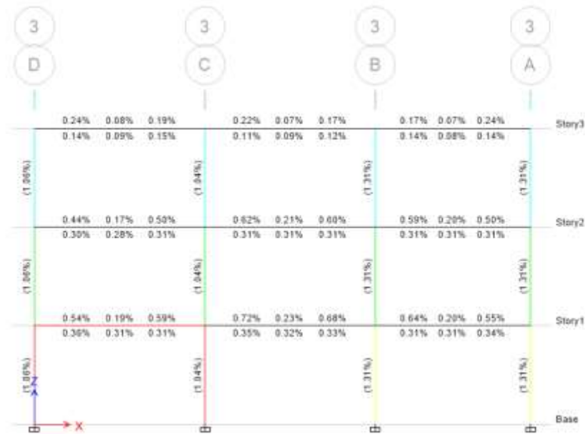
Figura 60 Cuantía de acero de vigas y columnas-Bloque 1A, eje 3
