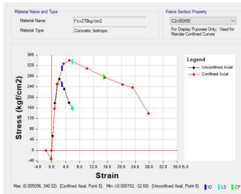
Figura 102 Diagrama de esfuerzo- deformación para un hormigón de f'c 260 kg/cm 2
