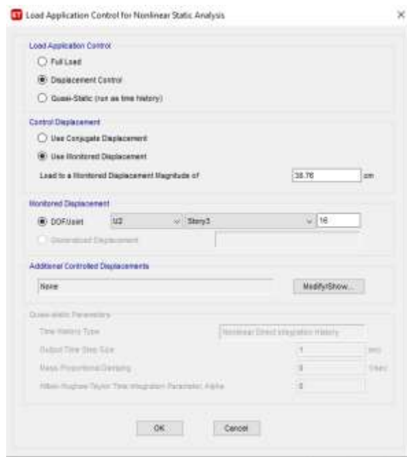
Figura 108 Control de aplicación de la carga en el Sentido Y
