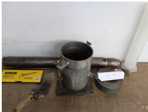
Imagen N° 25: Equipo de compactación
