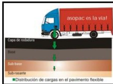
Imagen N° 3: Distribución de cargas en el Pavimento Flexible
