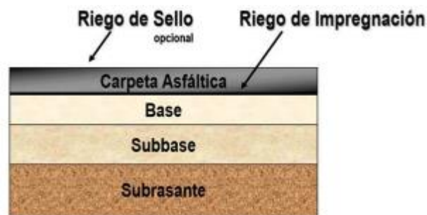
Imagen N° 4: Detalle de la estructura del pavimento flexible
