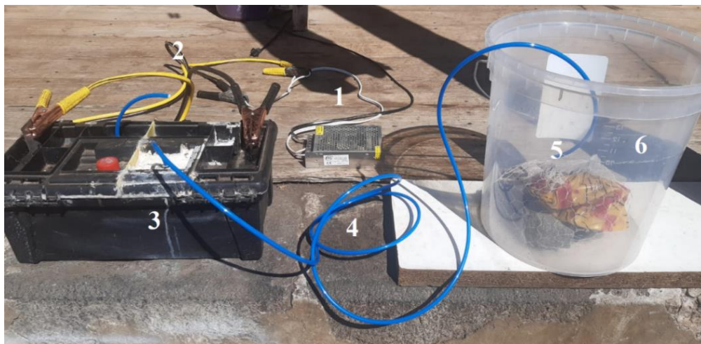
Figura 35: Esquema de medición por diferencias volumétricas.
