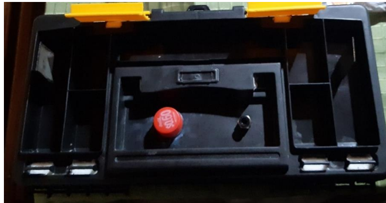
Figura 48: Colocación de entrada de agua y acople rápido.
