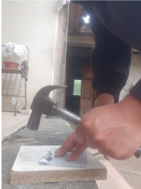
Figura 43: Enderezado de celdas de acero Inox AISI 304.
