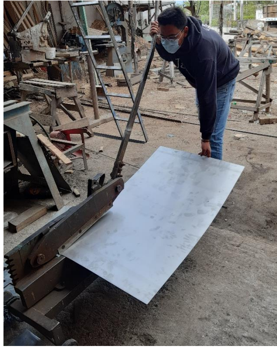
Figura 41: Corte de plancha de acero Inox AISI 304.
