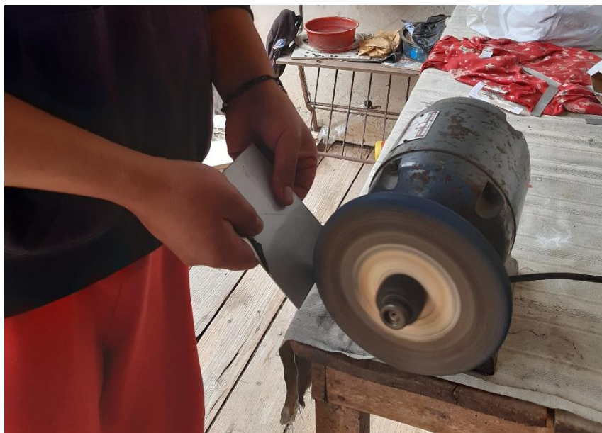
Figura 44: Esmerilado de celda de acero Inox AISI 304
