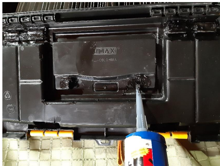
Figura 40: Colocación de silicón negro en sima de tapas 3D.
