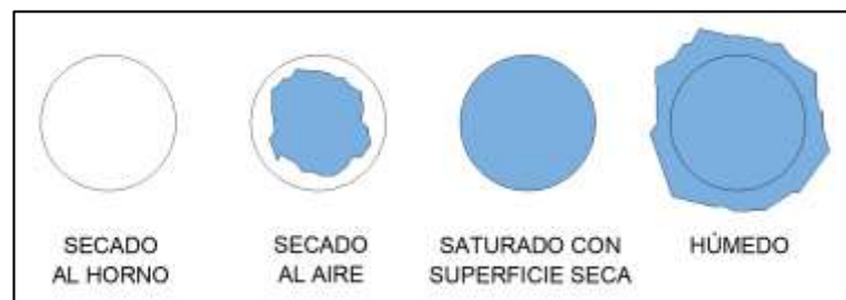
Figura 3. Estado de humedad de los agregados
