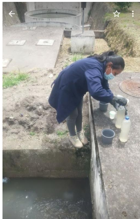
Figura 36: Toma de muestras de la entrada del PTAR.
