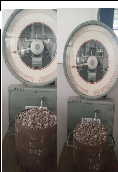
Fotografía 17.- Densidad Aparente de los Agregados - Piedra Pómez TMN= 19mm.
