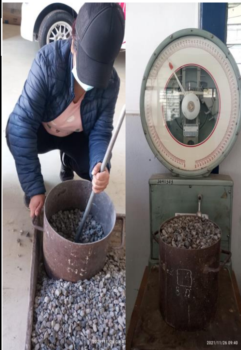
Fotografía 19.- Densidad Aparente de los Agregados - Ripio TMN= 19mm.
