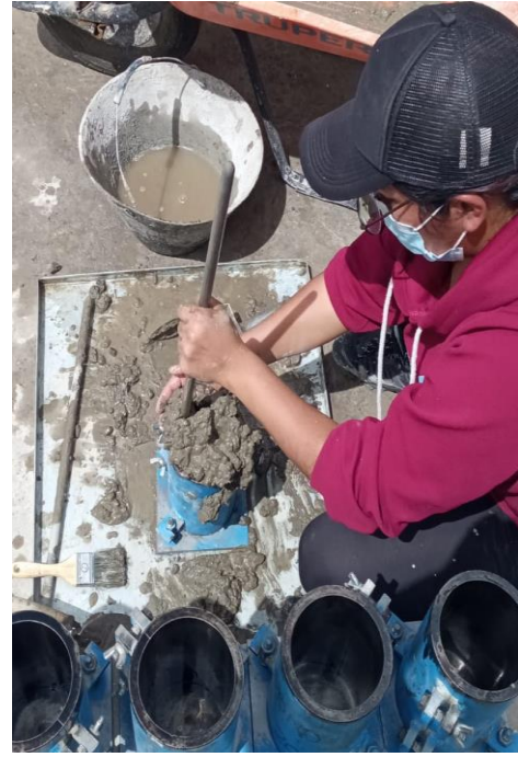
Fotografía 50.- Compactación en capas por varillado.
