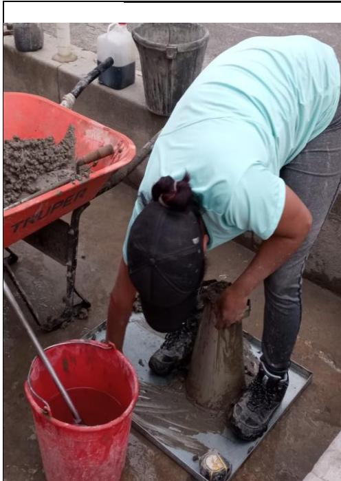
Fotografía 37.- Prueba de asentamiento por el Cono de Abrams- Limpieza de excesos alrededor del cono.
