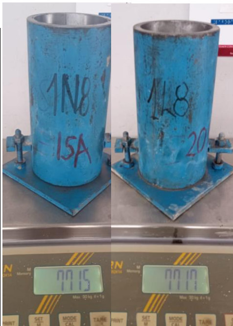
Fotografía 23.- Notación y pesaje de moldes cilíndricos para hormigón convencional y ligero con 0.8% superplastificante.
