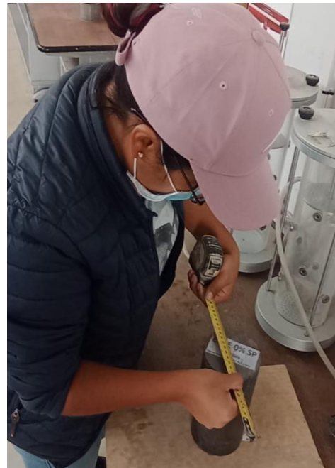
Fotografía 60.- Verificación de las dimensiones de los cilindros - diámetro 10cm a los 14 días de edad.
