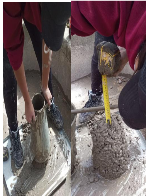
Fotografía 48.- Prueba de asentamiento por el Cono de Abrams- Levantamiento de cono y medición del asentamiento.
