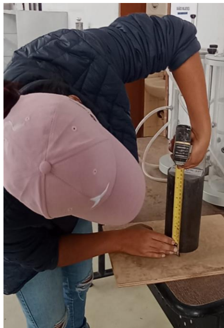
Fotografía 61.- Verificación de las dimensiones de los cilindros - altura 20 cm a los 14 días de edad.
