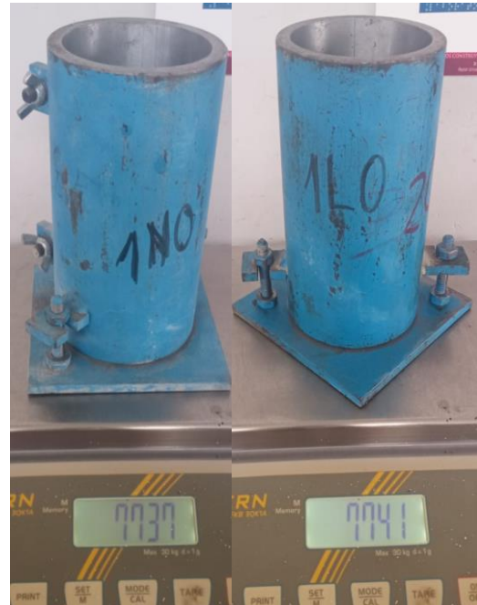
Fotografía 22.- Notación y pesaje de moldes cilíndricos para hormigón convencional y ligero con 0% superplastificante.
