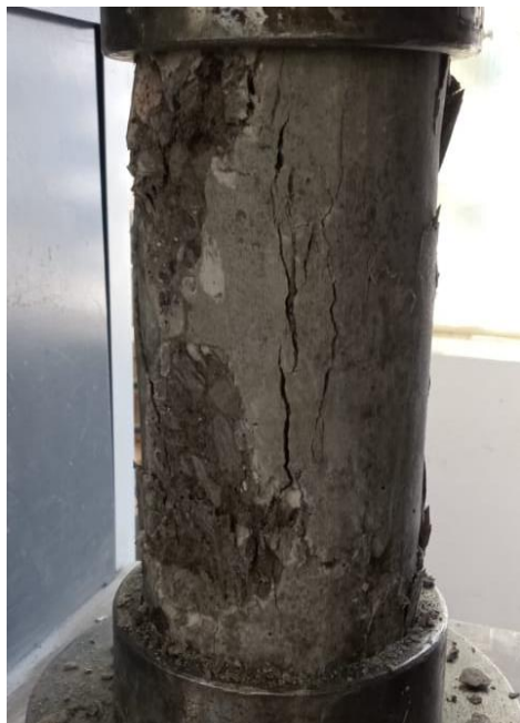
Fotografía 81.- Esquema de falla - Hormigón Ligero.
