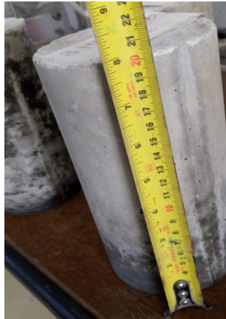
Fotografía 70.- Verificación de las dimensiones de los cilindros - altura 20 cm a los 28 días de edad.
