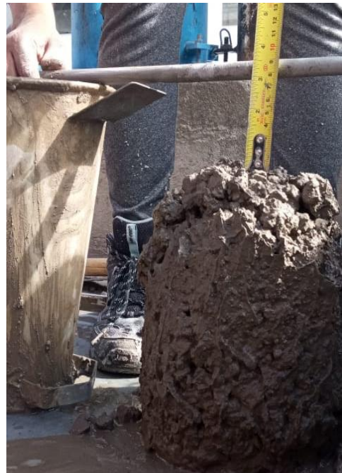
Fotografía 40.- Prueba de asentamiento por el Cono de Abrams- Medición del asentamiento.
