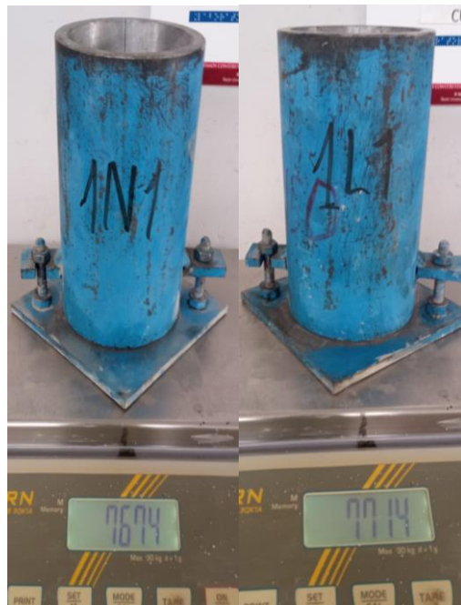
Fotografía 24.- Notación y pesaje de moldes cilíndricos para hormigón convencional y ligero con 1% superplastificante.
