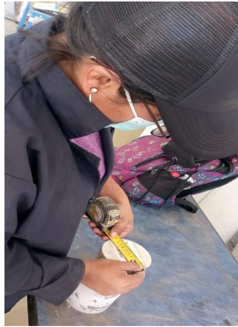
Fotografía 64.- Verificación de las dimensiones de los cilindros - diámetro 10cm a los 28 días de edad.
