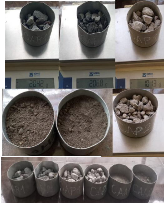
Fotografía 14.- Densidad Real del Agregado Grueso Ligero - Piedra Pómez TMN= 19mm.
