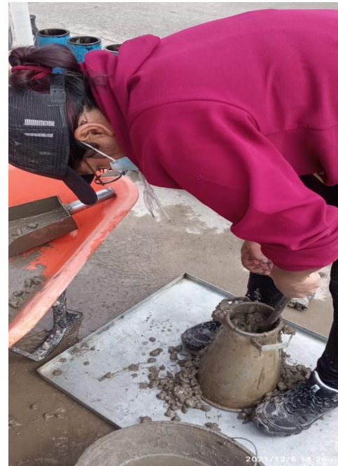
Fotografía 36.- Prueba de asentamiento por el Cono de Abrams- Compactación por varillado.
