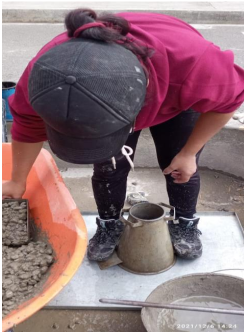
Fotografía 35.- Prueba de asentamiento por el Cono de Abrams- Vertido de mezcla.
