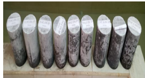
Fotografía 56.- Preparando los cilindros para ensayos de densidad y resistencia a compresión.
