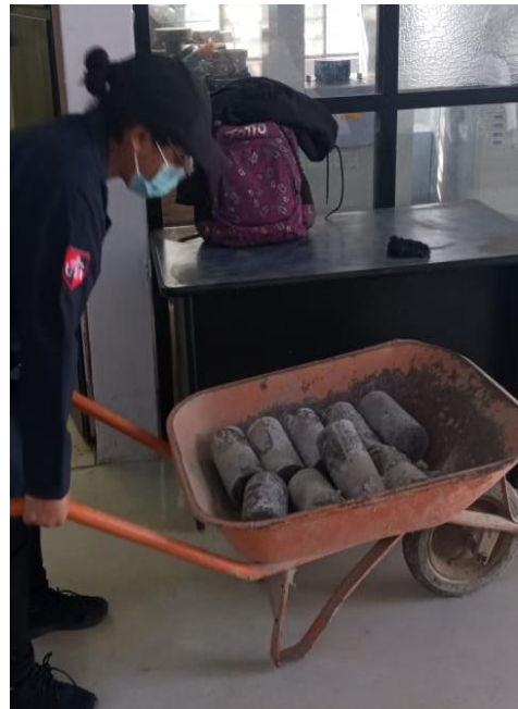
Fotografía 82.- Escombros procedentes de los cilindros ensayados.
