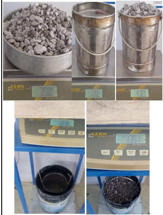
Fotografía 14.- Densidad Real del Agregado Grueso Ligero - Piedra Pómez TMN= 19mm.
