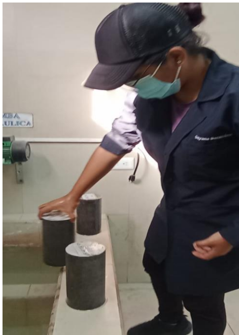
Fotografía 55.- Retirando los cilindros de la cámara de curado para ensayos de densidad y resistencia a compresión.
