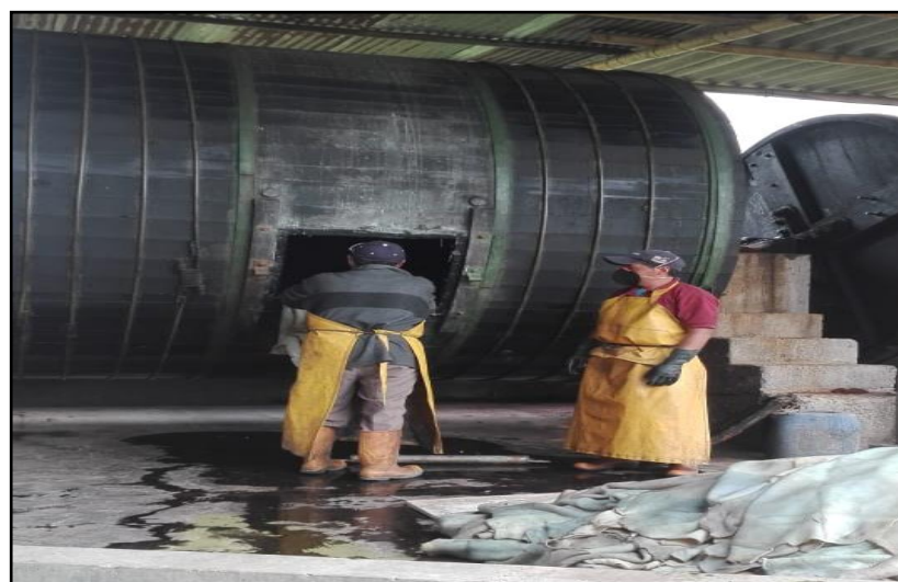
Figura 8. Proceso de pelambre.
