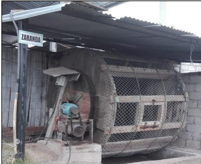
Figura 18. Proceso de zaranda.
