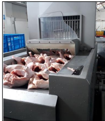
Figura 28: Proceso de inyectado.
