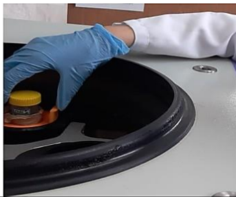
Centrifugado de la biomasa y resuspensión en solución salina
