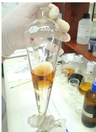
**Figura 13** Separación de la fase orgánica en la reacción para Cafeína.
