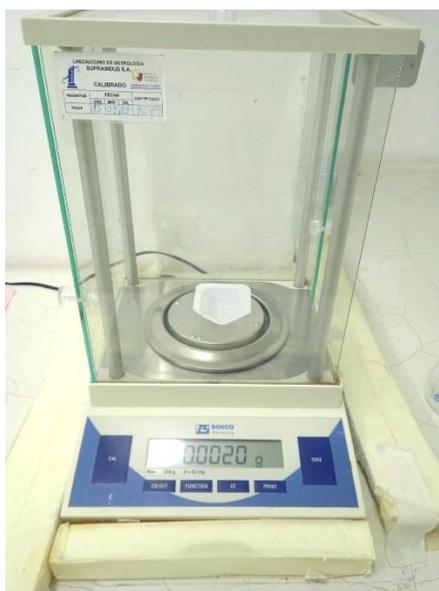
**Figura 14** *Uso de la balanza analítica BOECO BBL31 para pesar los mg necesarios para cada estándar*
