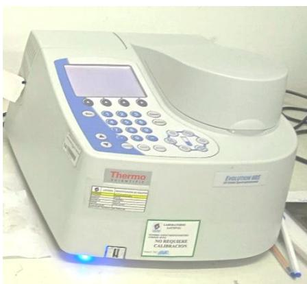
**Figura 7** *Equipo espectrofotométrico UV-VIS EVOLUTION 60s.*
