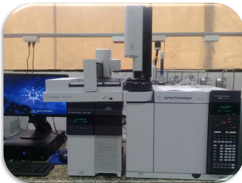
Figura 7. Cromatógrafo de gases Agilent Technologies 7890B GC System equipado con un detector de masa 5977A GC/MSD autosampler 7693
