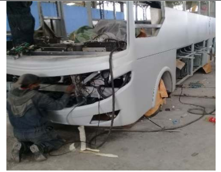
Instalaciones eléctricas inferiores
