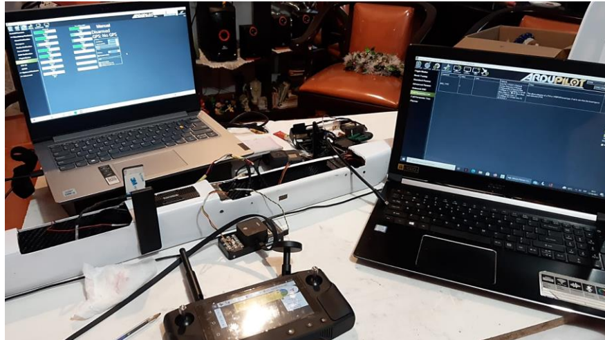
Figura 47. Pruebas de funcionamiento del Sistema de Telemetría en Tierra.
