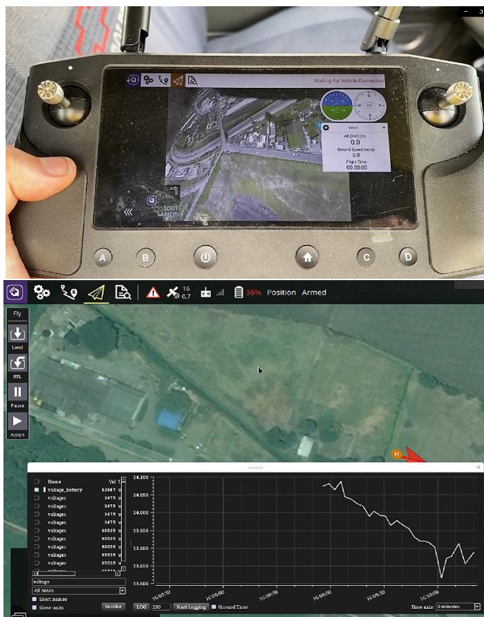
Figura 55. Señal de video enviada desde el UAV y receptada en la Estación de Control.
