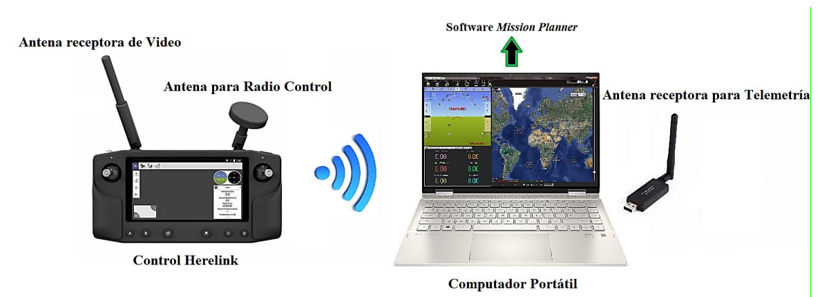
Figura 46. Conexión de equipos ubicados en la Estación de Control en Tierra
