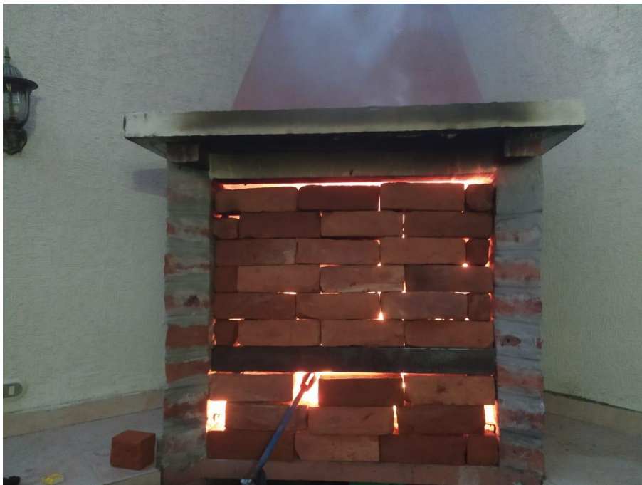
Anexo F. Enfriamiento con agua, simulando un evento real.
