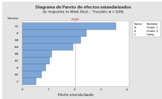
Figura 3-11. Diagrama de Pareto de efectos estandarizados de Módulo de Elasticidad a Tracción.
