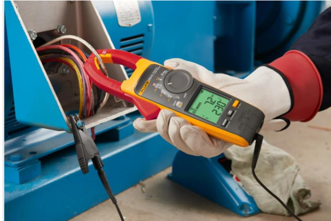
Figura 22. Toma de datos en motor trifásico.
