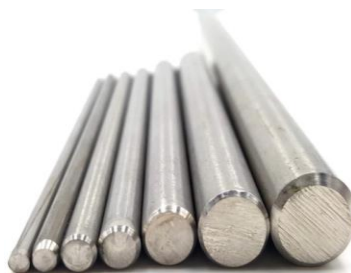
Figura 16: Acero de transmisión AISI 1018 [22].
