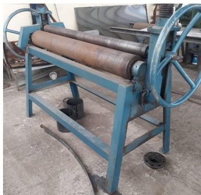
Figura 27: Roladora de placa [Autor].
