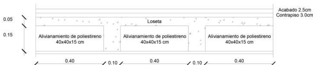
Figura 26. Corte de losa
