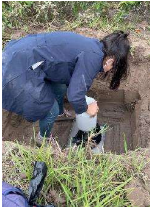
Figura 14: Densidad en campo por el método de Cono y Arena de Ottawa
