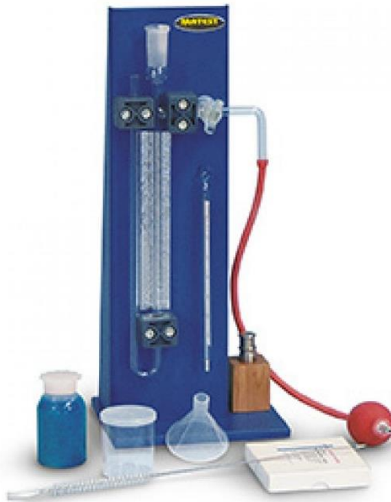
Figura. 8 Aparato Blaine de permeabilidad al aire[71]
