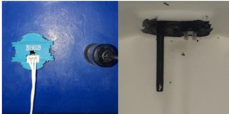
**Figura 69.** Implementación de los sensores de pH y turbidez en el tanque.
