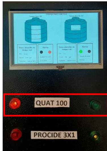
**Figura 83.** Alerta lumínica cuando el nivel del tanque Quat 100 se encuentra casi vacío.
