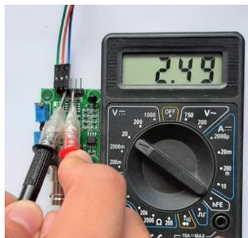
**Figura 28.** Medición del voltaje en el pin Po el sensor de pH.
