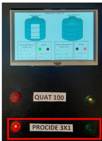
**Figura 81.** Alerta lumínica cuando el nivel del tanque Procide 3x1 se encuentra casi lleno.
