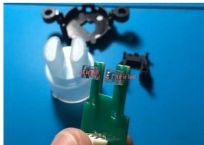
**Figura 30.** Transmisor y receptor infrarrojos del sensor de turbidez.
