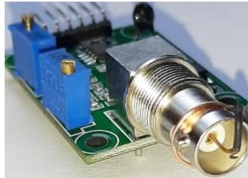
**Figura 27.** Cortocircuito del conector BNC del sensor de pH.
