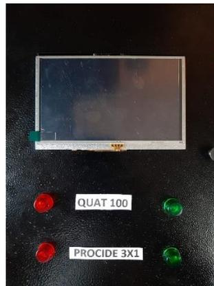
**Figura 67.** Implementación de la pantalla TFT e indicadores visuales en la puerta del case metálico.
