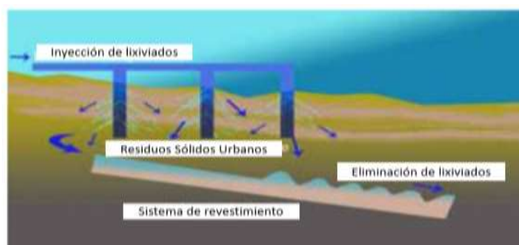
Fig. 16 Inyección en pozos verticales (Thampan & Chandel, 2015).
