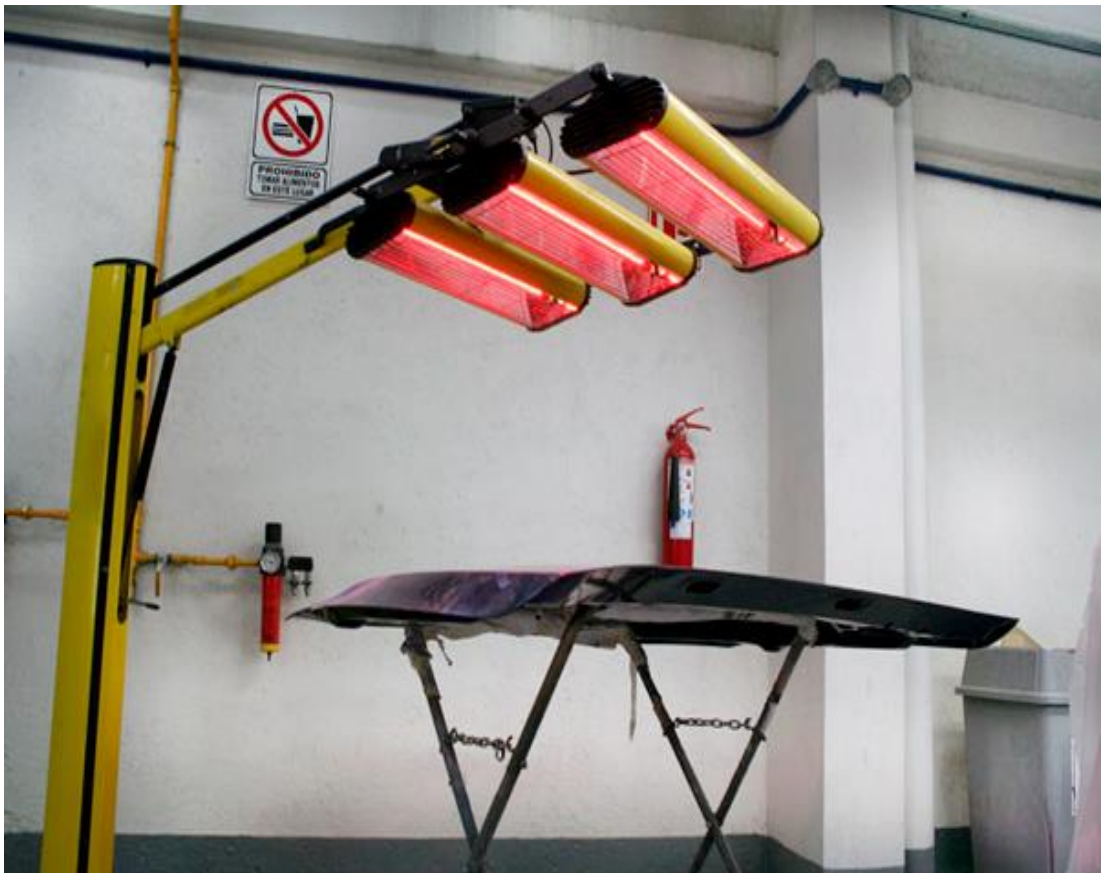
Figura 20.- Lampara de Secado de pintura [18].
