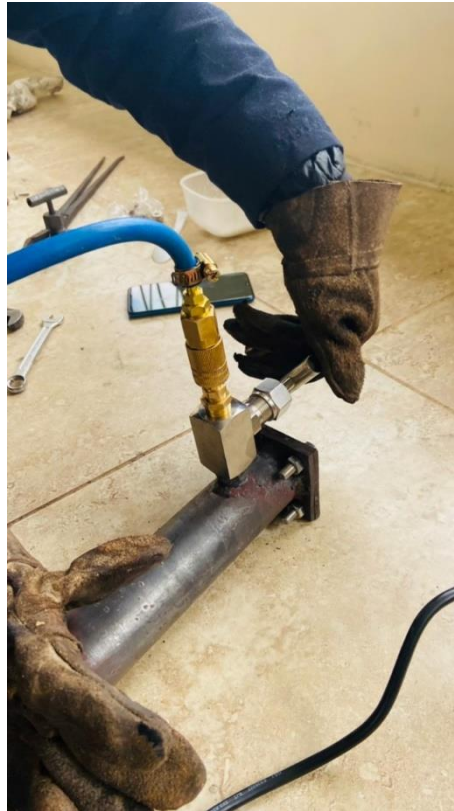
Proceso de apertura de gas inerte, enfriamiento brusco.
