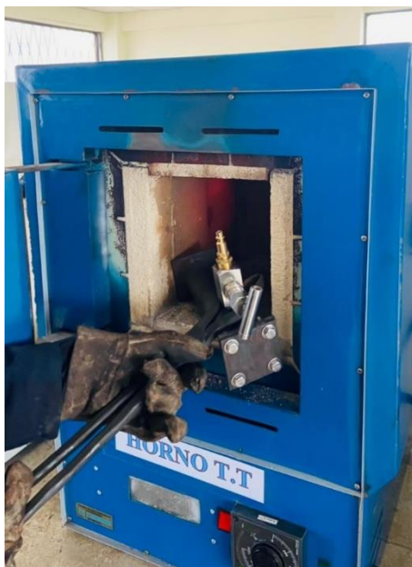
Salida del molde desde el horno, con pinzas de acero.
