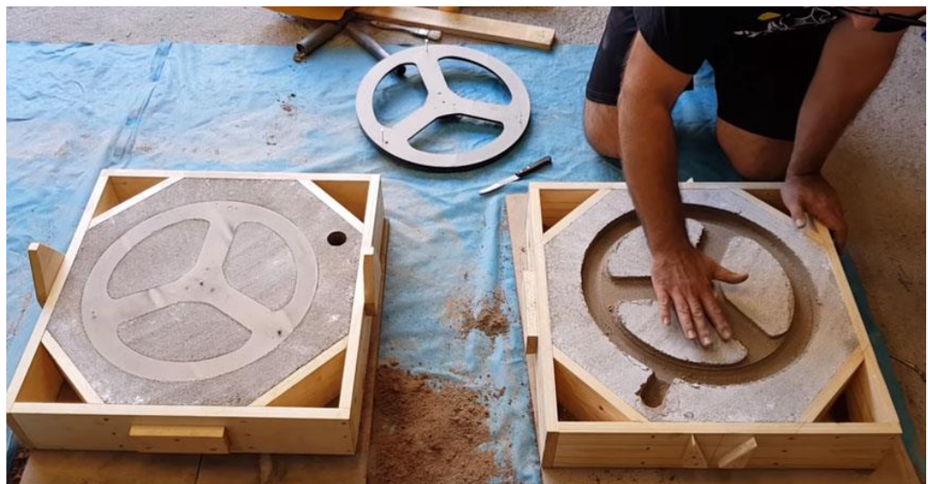
Figura 6: Fundición en arena [7].
