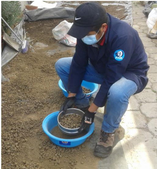
Preparando muestra para ensayo de proctor modificado
