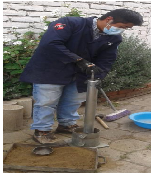
Compactación de la muestra de suelo en 5 capas de 56 golpes con martillo de 10lb a una altura de 18"
