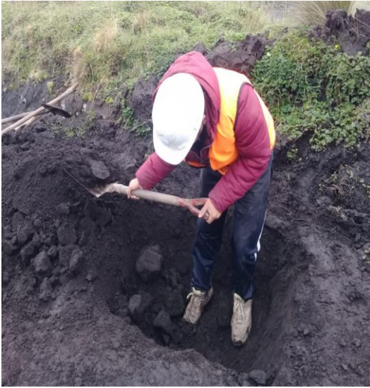
Excavación de calicata.
