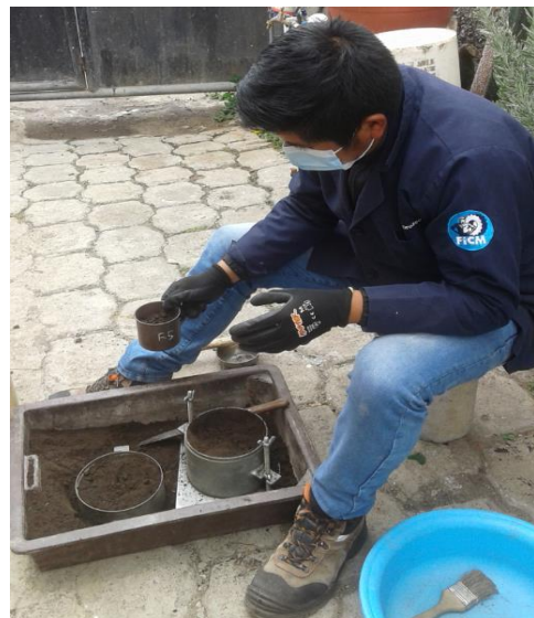
Compactación de la muestra de suelo en 5 capas de 56 golpes con martillo de 10lb a una altura de 18"
