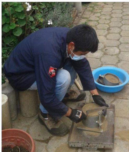
Enrasando la muestra de suelo para posteriormente tomar su peso.
