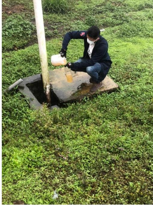
**Figura 42.** Toma de muestra del agua residual a la salida de la PTAR.
