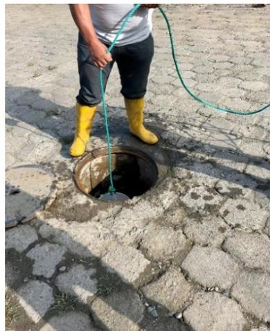
**Figura 6:** Medición de caudales de ingreso a la PTAR
