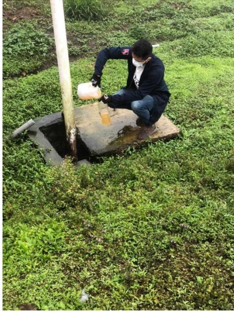
**Figura 9:** Obtención de muestra a la salida de la PTAR.
