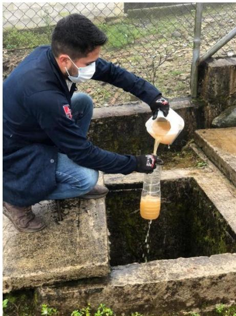
**Figura 8:** Obtención de muestra a la entrada de la PTAR.
