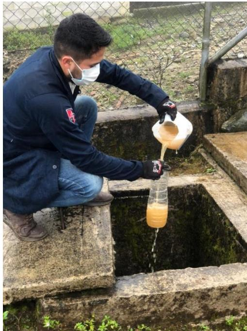
**Figura 41.** Toma de muestra del agua residual a la entrada de la PTAR.
