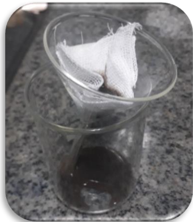
Foto 3. Filtración de la mezcla.
