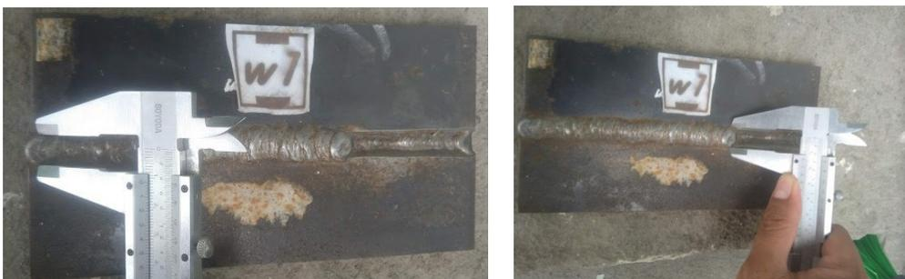
**Figura 2.11. Mediciones de ancho de cordón en probeta w1**
