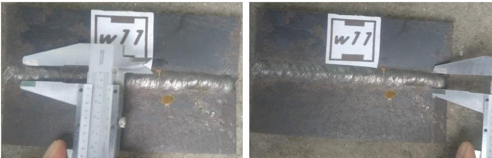
**Figura 2.21. Mediciones de ancho de cordón en probeta w11**
