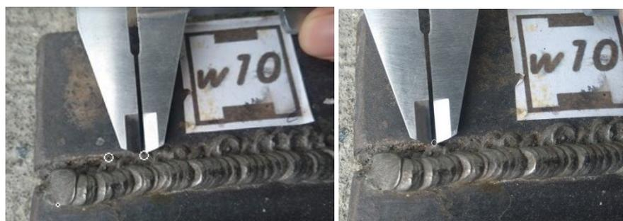
**Figura 2.26. Mediciones de porosidad en el cordón de soldadura.**
