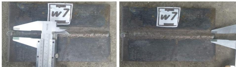
**Figura 2.17. Mediciones de ancho de cordón en probeta w7**
