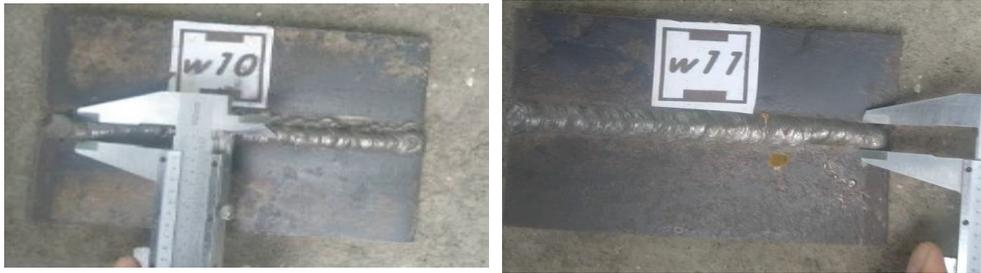
**Figura 2.20. Mediciones de ancho de cordón en probeta w10**
