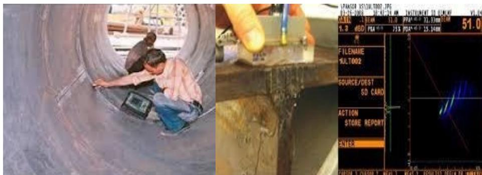
**Figura 1.43. Técnica de inspección por Ultrasonido (UT)**
