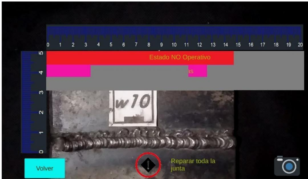
**Figura 2.31. Mediciones de socavación en color morado en w10**
