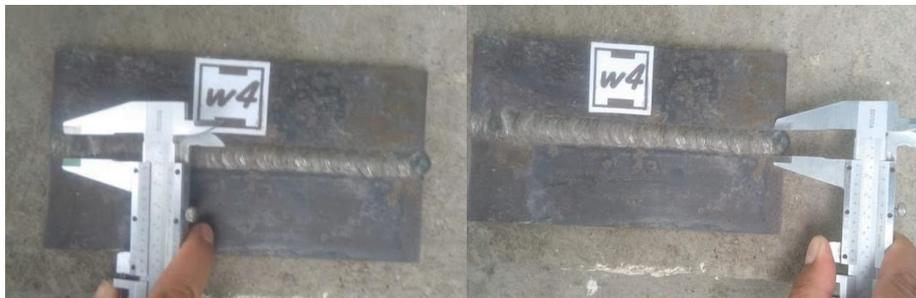
**Figura 2.14. Mediciones de ancho de cordón en probeta w4**
