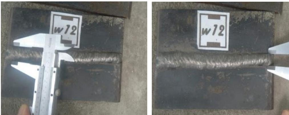
**Figura 2.22. Mediciones de ancho de cordón en probeta w12**
