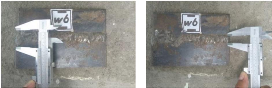
**Figura 2.16. Mediciones de ancho de cordón en probeta w6**
