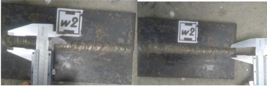
**Figura 2.12. Mediciones de ancho de cordón en probeta w2**
