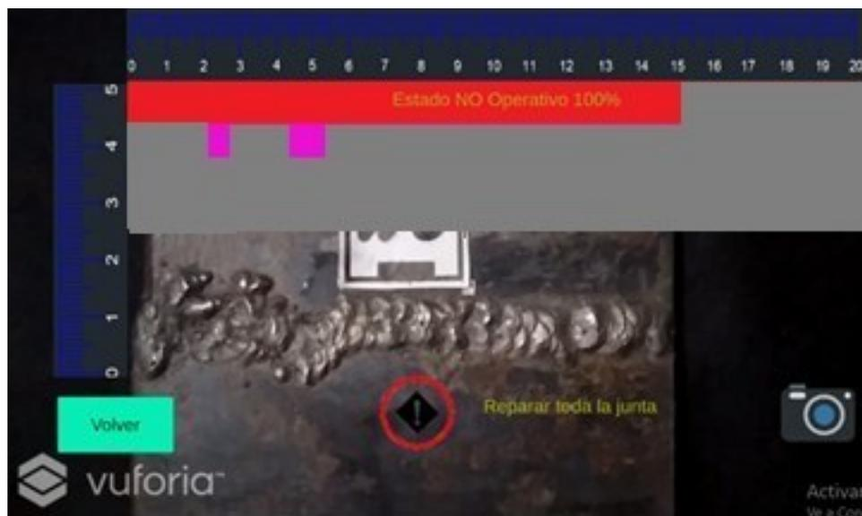
**Figura 2.30. Mediciones de socavación en color morado en w6**
