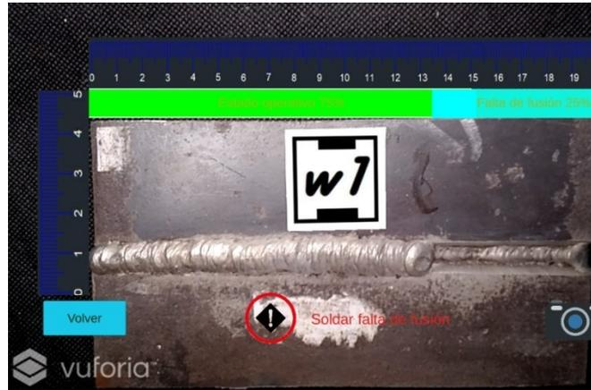
**Figura 2.33. Mediciones de falta de fusión en w1**
