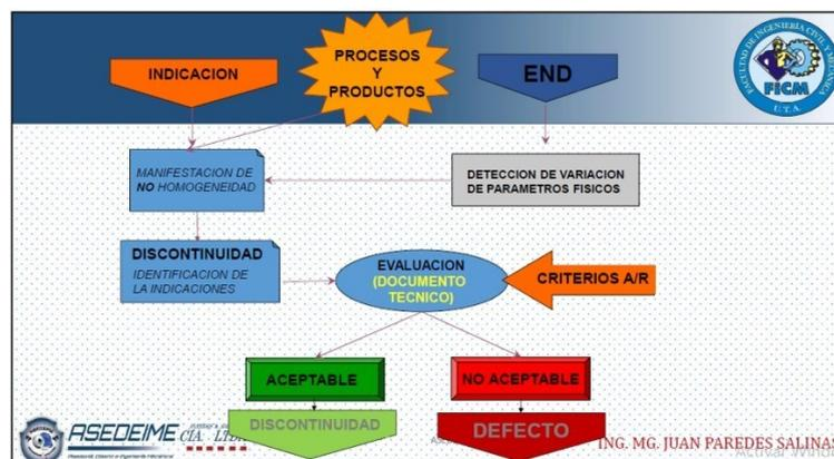
Figura 1.20. Diagrama de procesos de control de calidad
