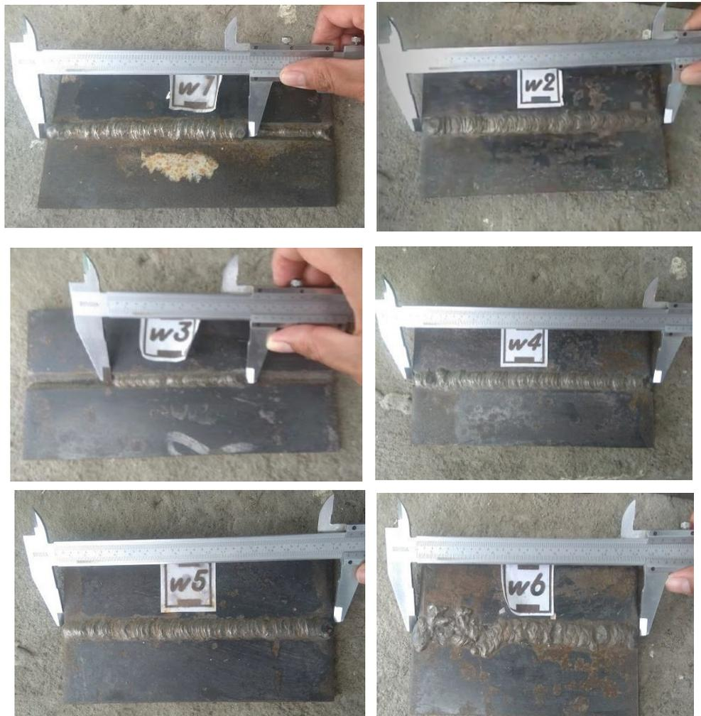
**Figura 2.23. Mediciones de longitud de cordón desde w1-w6.**
