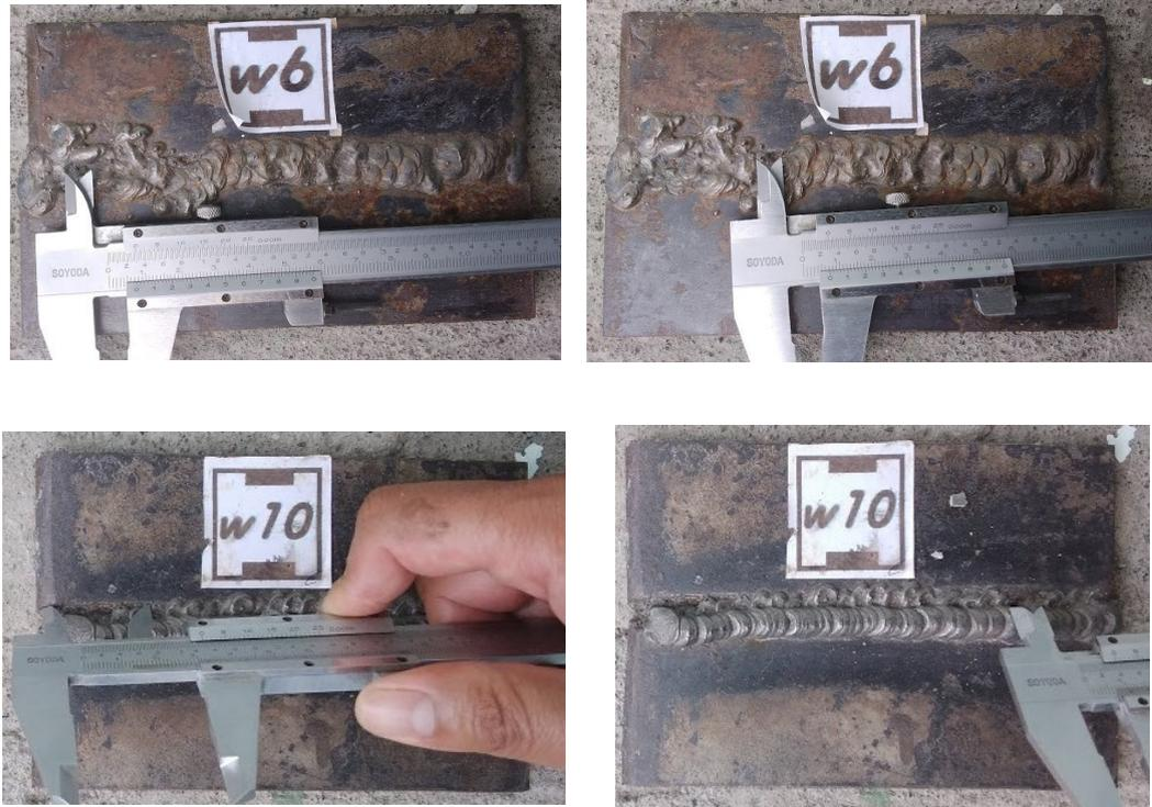
**Figura 2.25. Mediciones de socavación en el cordón de soldadura.**
