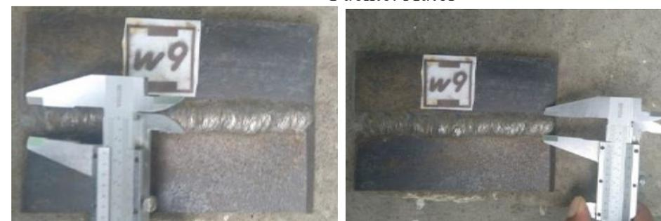
**Figura 2.19. Mediciones de ancho de cordón en probeta w9**
