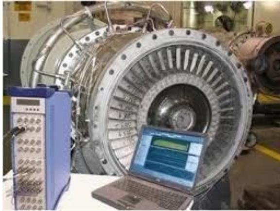
**Figura 1.42. Equipos de inspección por análisis de vibraciones**
