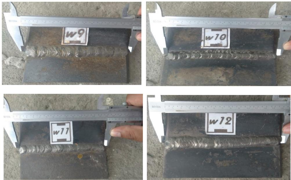
**Figura 2.24. Mediciones de longitud de cordón desde w7-w12.**
