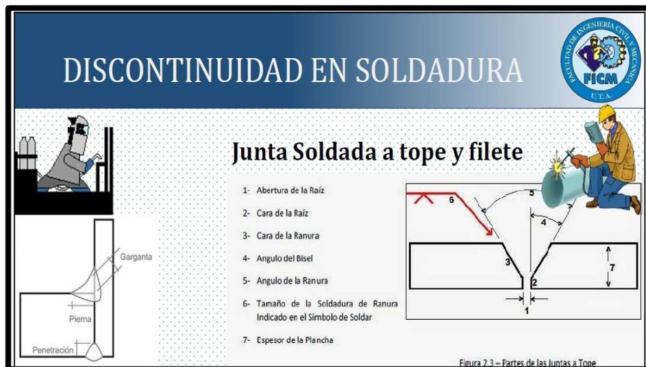
**Figura 1.21. Junta soldada a tope y filete**
