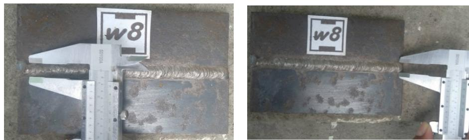
**Figura 2.18. Mediciones de ancho de cordón en probeta w8**
