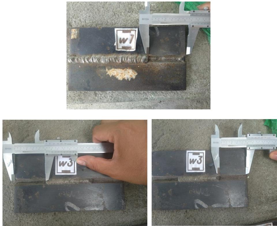
**Figura 2.27. Mediciones de falta de fusión en cordones de soldadura**
