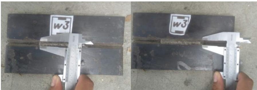
**Figura 2.13. Mediciones de ancho de cordón en probeta w3**
