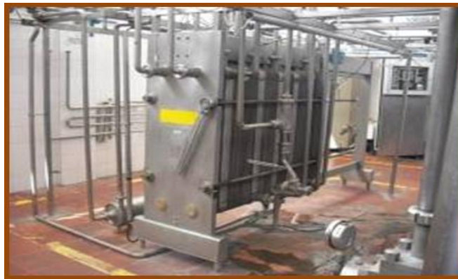
Grafico 8: Ultra Pasteurizador para leche envasada en APP (fundas plásticas) – Esterilizador para leche envasada en UHT (Tetrapack).
