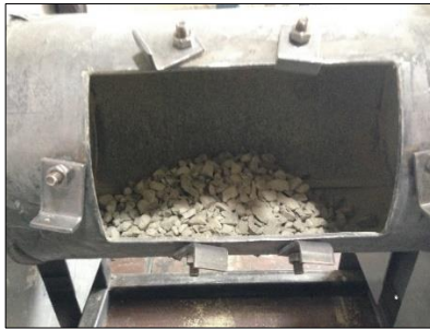
Figura 15: Molino de bolas Fuente: Fabian Ramos
