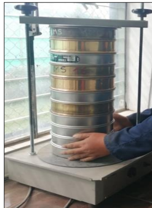
Figura 16: Tamizadora eléctrica Fuente: Fabian Ramos
